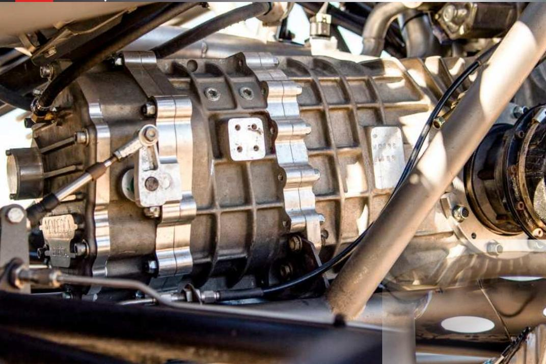
LEFT: POWER FROM THE 2.4L IS TRANSFERRED THROUGH A MENDEOLA SEQUENTIAL FIVE-SPEED TRANSMISSION BY MCDOWELL PERFORMANCE
