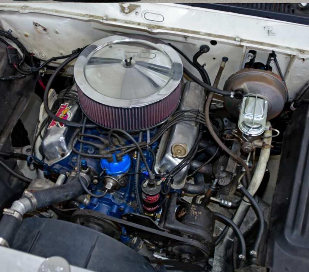
**LEFT: A BUILT FORD 351C1 V-8 NOW POWERS THE 1970 FORD F-100 PICKUP. A FORD 302C1 V-8 WAS THE ORIGINAL ENGINE. A THREE-SPEED AUTOMATIC TRANSMISSION CARRIES THE POWER TO THE REAR DANA 44 AXLE.**
