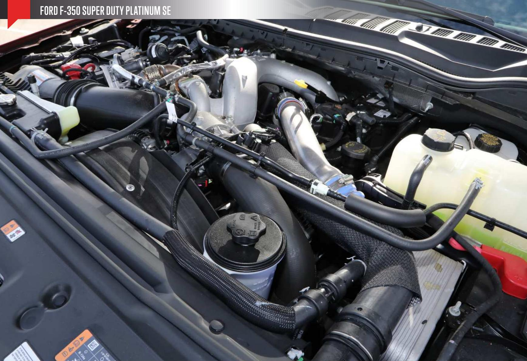
UNDER THE HOOD IS A POWERFUL 6.7L POWER STROKE TURBO DIESEL V8 BACKED BY A 10-SPEED AUTOMATIC TRANSMISSION THAT HAS GREAT TOWING CAPABILITIES.
